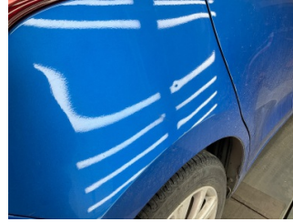
Çamurluk, sağ arka, Çamurluk, sağ arka > Ezik
