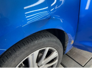
Çamurluk, sol, Çamurluk, sol > Hasarlı
