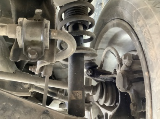
Arka aks, Amortisör, arka sağ > Yağ Kaçağı
