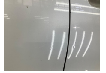
Kapı, sağ arka, Kapı, sağ arka > Çizik
