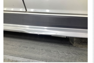
Marşbiyel, sol, Marşbiyel plastiği, sol > Hasarlı
