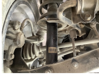
Arka aks, Amortisör, arka sol > Yağ Kaçağı
