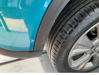
Çamurluk, sağ arka, Çamurluk ağzı > Çizik
