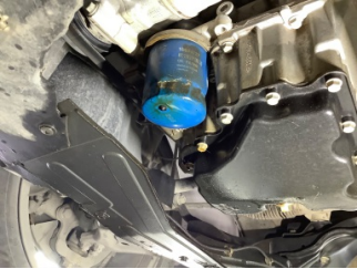
Motor, Motor > Yağ Kaçağı
