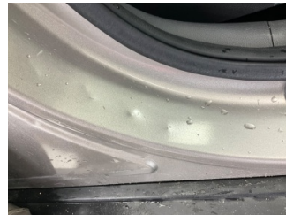
Kaporta, A-direk, sağ > Hasarlı
