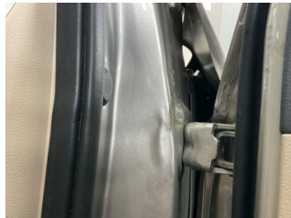
Kaporta, A-direk, sağ > Hasarlı
